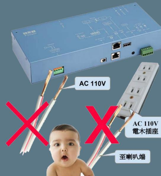
圖三：現場強、弱電誤接導致設備故障示意圖
