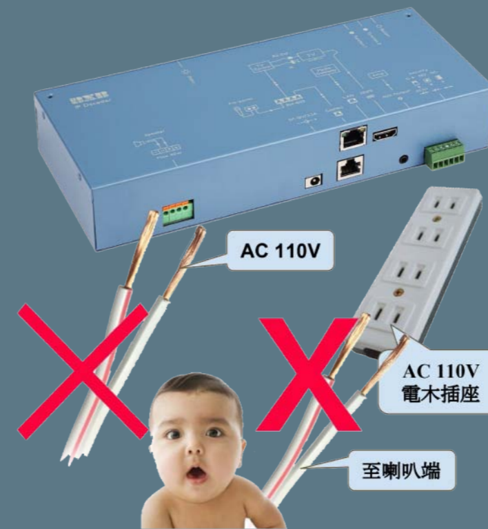
图三：现场强、弱电误接导致设备故障示意图
