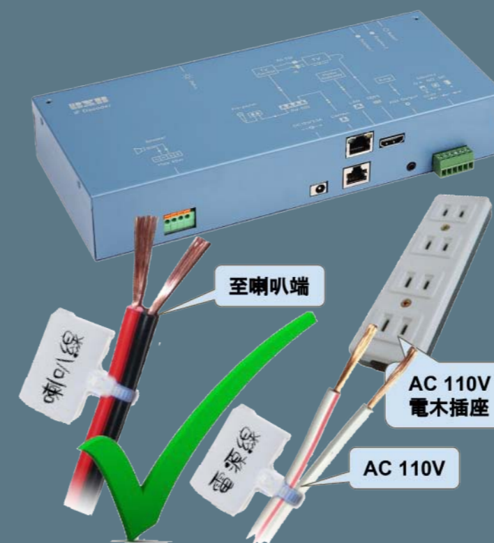
图四：强、弱电建议使用方式
