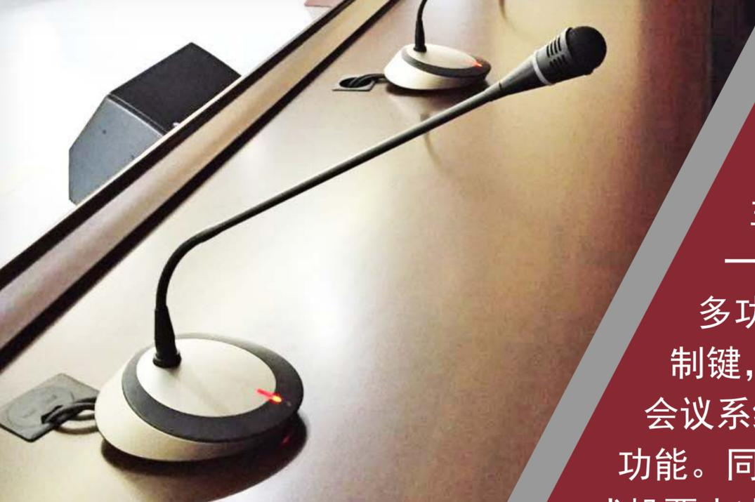
另外，于多功能厅中所安装的第2间会议室，则是采用FCS桌上型会议麦克风，麦克风单体具液晶显示屏，可同步显示会议主机所有的设定及发言状态。同时还提供了一个贴心的功能，主席麦克风单体上的5只多功能控制键，等同于会议主机上的5个控制键，方便主席更改主机之发言模式及调整会议系统输出音量大小，执行会议秩序管理功能。同时，主列席麦克风单体皆内建掀盖式投票表决功能接口，让投票时具有隐密性，单体具备5个LED确认指示器的投票表决键，再搭配上BXB图形化会议管理软件即可由主席单体或会议图控软件直接启动投票表决功能，并可从图控液晶画面显示投票统计结果。BXB图形化会议管理软件，提供14国语言可选择，可执行下列多项功能：音量调整、投票功能、摄像机发言追踪与录音存盘等，亦可编辑与会人员资料，并根据实际会议环境座位配置麦克风位置，实现更便利且多功能性的会议环境。
