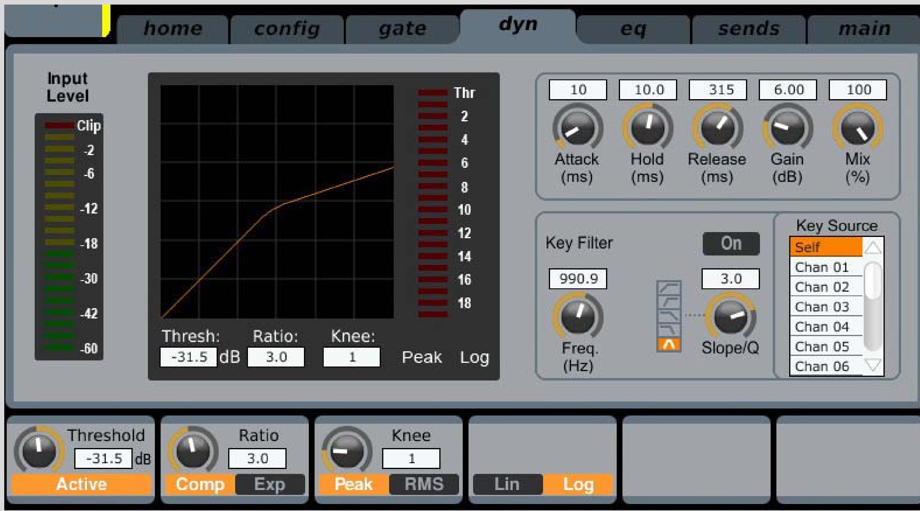
圖三：是x32混音器內帶的壓縮器，提供了各種參數可以調整，圖上的例子是3：1壓縮，閾點是-31.5dBFS，輸出增益為+6dB
