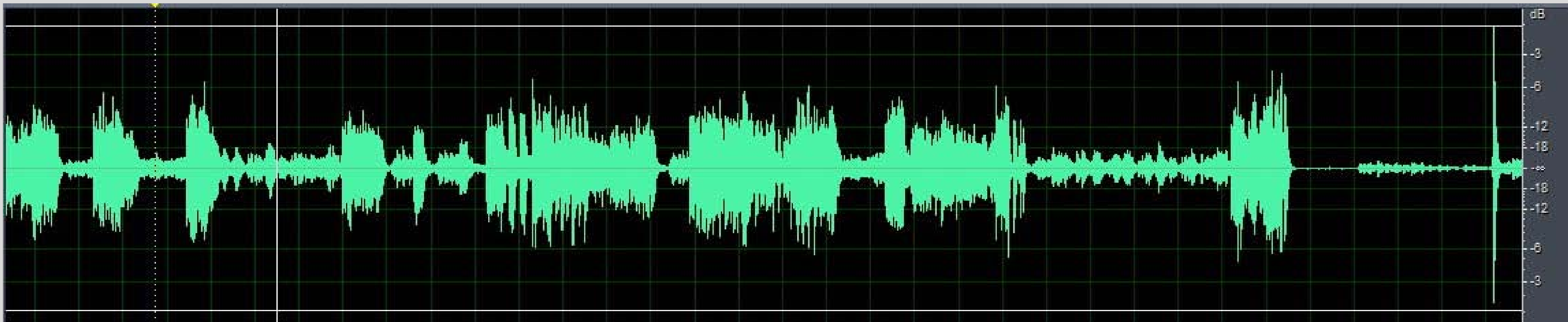
图二：为惊愕交响曲的部分信号电平值，表头单位是dBFS，可以看到大部分信号约为-6~-12 dBFS，较为安静的小节甚至是-18dBFS，最右边的高点就是最为高潮的弦乐+定音鼓桥段，把所有动态空间用满。
