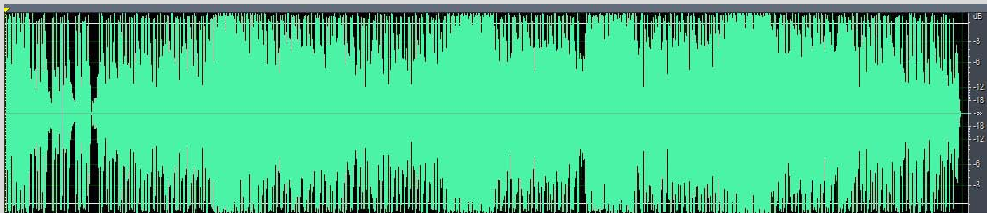
图一：这是Beyonce "Freakum Dress"音频档案波形可以发现都是尽可能的往满电平做混缩
