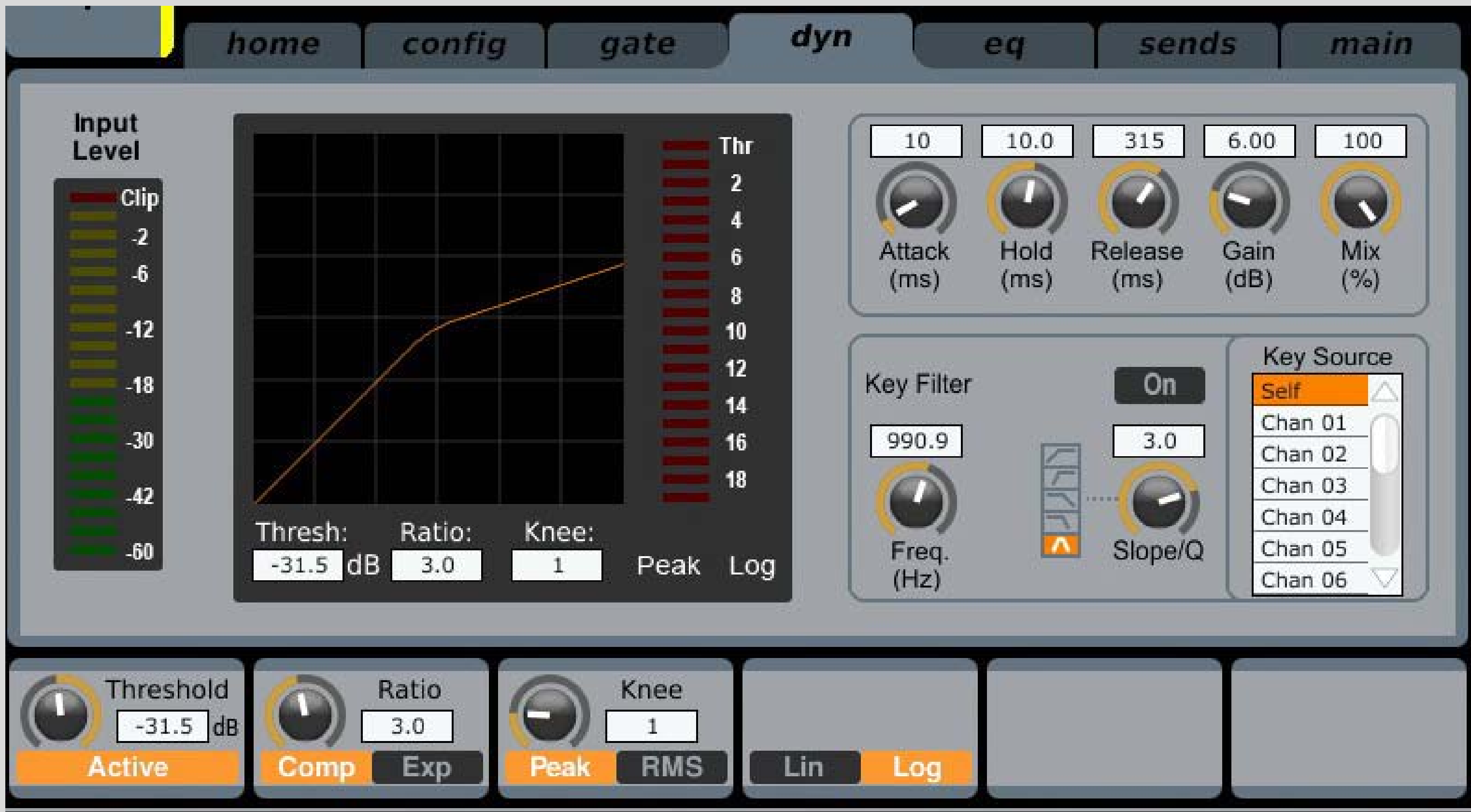
图三：是x32混音器内带的压缩器，提供了各种参数可以调整，图上的例子是3：1压缩，阀点是-31.5dBFS，输出增益为+6dB
