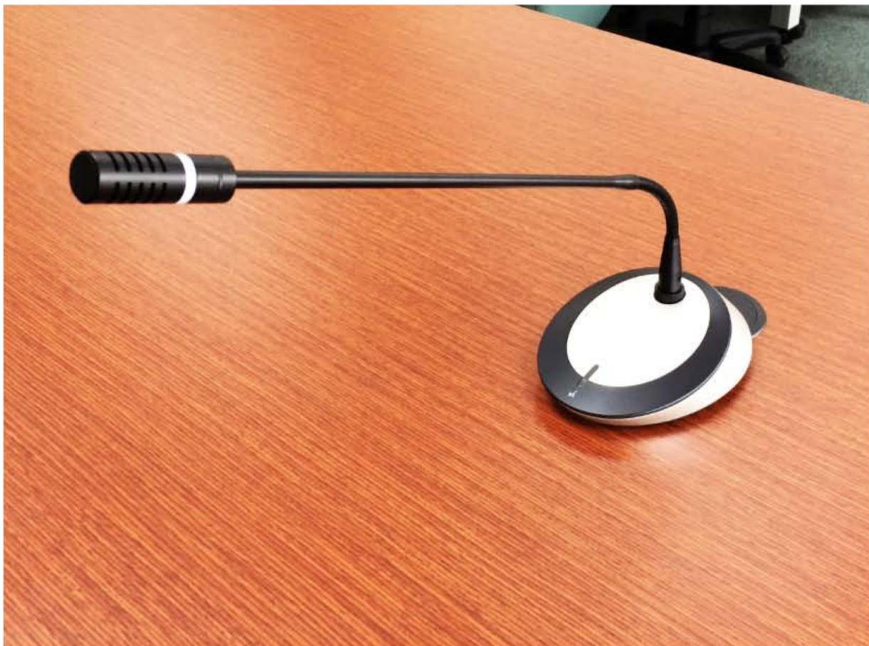
除了滿足校方在線材建置上的需求外，BXB FCS-6300系列的主機具備TCP/IP通信協定網路控制，可透過有線及無線網路方式，使用電腦及手持行動裝置 (I-PAD/I-PHONE) 直接與會議主機連線，可於網頁瀏覽器中進行各種會議秩序更改及指定列席麥克風發言。並可直接連動HD高畫質高速迴轉攝影機，執行發言者自動定位追蹤之功能。並搭配極具質感及流線型設計的UFO數位會議麥克風，此麥克風面板是由多種金屬色系所搭配，共有25種色系組合，可配合現場裝潢。此外會議麥克風單體同時具備數位DSP聲音處理芯片，擁有自動增益調整 (AGC) 及音質調整，並可從主機指定變更成主席或列席之身份。
