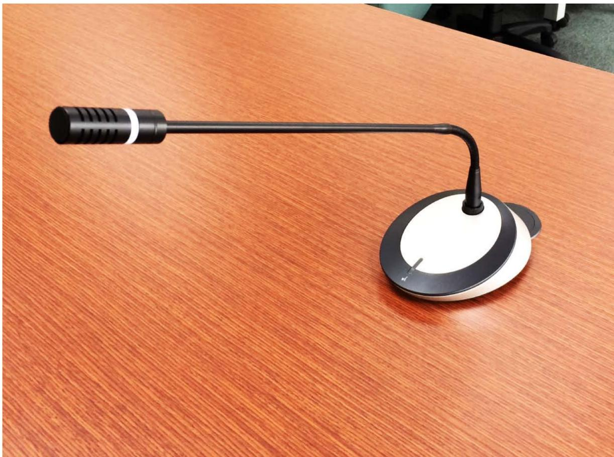
除了满足校方在线材建置上的需求外，BXB FCS-6300系列的主机具备TCP/IP通信协议网络控制，可透过有线及无线网络方式，使用计算机及手持行动装置(I-PAD/I-PHONE)直接与会议主机联机，可于网页浏览器中进行各种会议秩序更改及指定列席麦克风发言。并可直接连动HD高画质高速回转摄影机，执行发言者自动定位追踪之功能。并搭配极具质感及流线型设计的UFO数字会议麦克风，此麦克风面板是由多种金属色系所搭配，共有25种色系组合，可配合现场装潢。此外会议麦克风单体同时具备数字DSP声音处理芯片，拥有自动增益调整(AGC)及音质调整，并可从主机指定变更成主席或列席身份。
